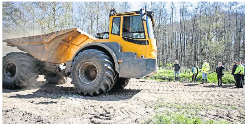
Um die Natur beim Umbau zu schonen, kommen beim Transport von Boden und Kies Spezialfahrzeuge wie dieser Dumper zum Einsatz.
